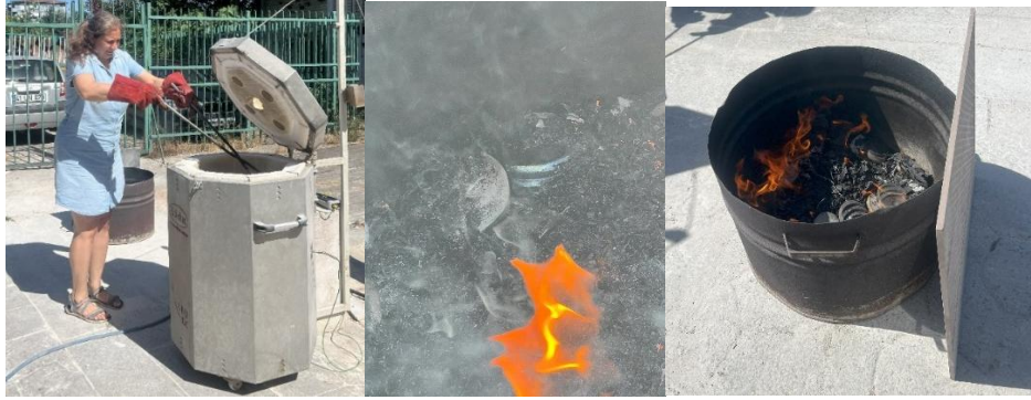
Görsel 1: Gazlı Fırında Yapılan Pişirim Sonrası İndirgeme İşlemi
