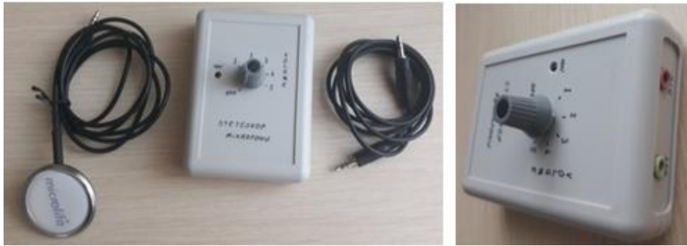
Şekil 5. Tasarlanmış Elektronik Stetoskop
