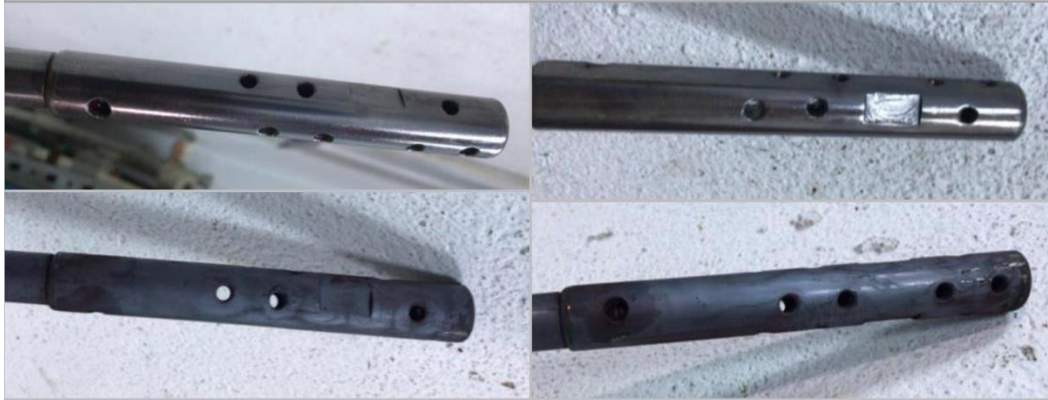
Şekil 2. Preheater çıkış kuponları (İnhibitör uygulamasında 48 saat sonra)
