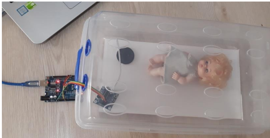
Şekil 7. ISD1820 Ses Kayıt Modülünün Kuvöze Yerleştirilmesi
