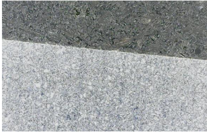
Şekil 7. Reckwalls ile üretilmiş parçanın yüzey kesitine ait IM görüntüsü (x5)
