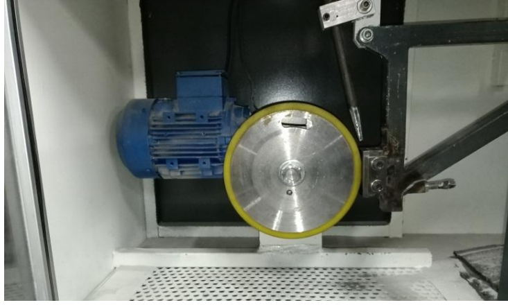
Şekil 2. Aşınma testi düzeneği
