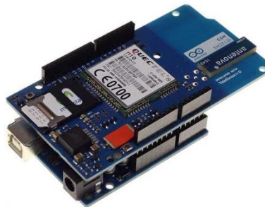
Şekil 4. Arduino GSM Modülü ve Arduino Uno
