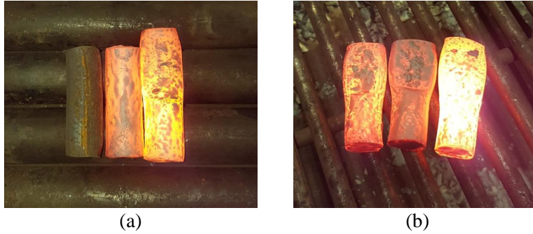
Şekil 1. Şahmerdan ile üretimi gerçekleştirilecek rotül parçasının ara kademe formlarını gösteren makro görüntüler; (a ve b) sıcak işlem görmüş formlar.
